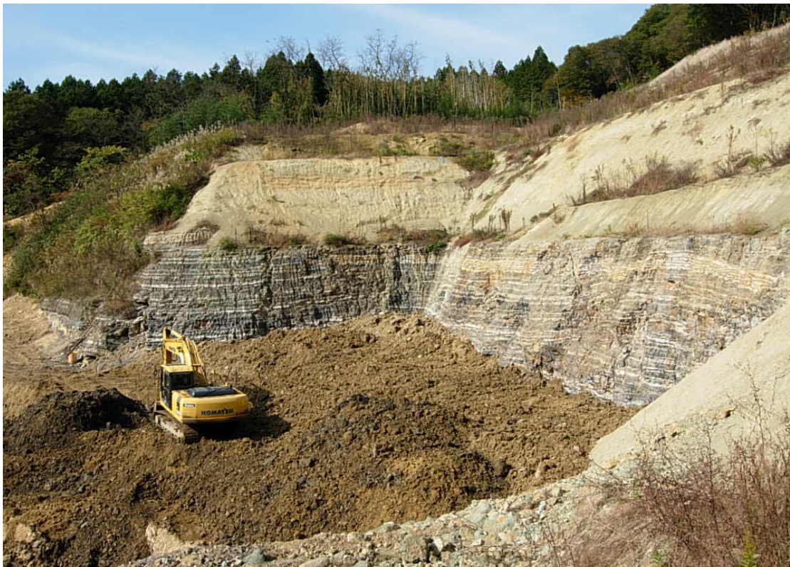
写真－1．亜炭層の露天掘り風景（写真提供：(株)トーケンヒロミ）
